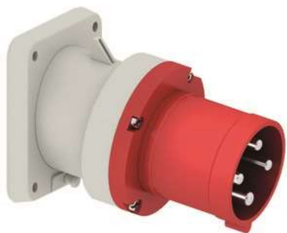
Панельная вилка с наклоном фланец 107x100 центры крепления 85x77
